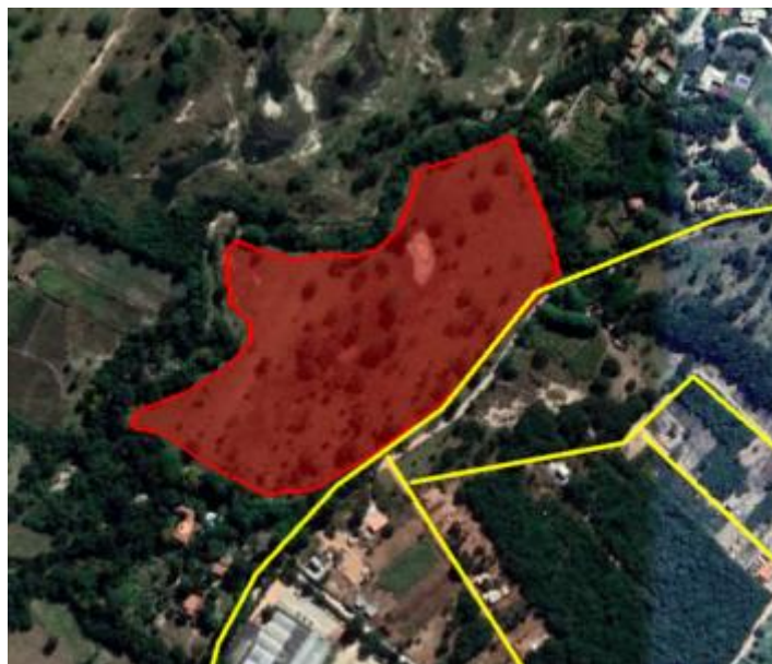
Figura 19 - Proximidade do terreno de implantação das casas populares (demarcado em vermelho) com a extensão em rede elétrica previsto no OBR-00000009 (linhas em amarelo) em Fortuna de Minas. Fonte: Google Earth Adaptado.
