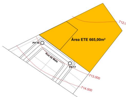
Imagem parcial da área do loteamento, reservada à ETE meramente ilustrativa, original em anexo
