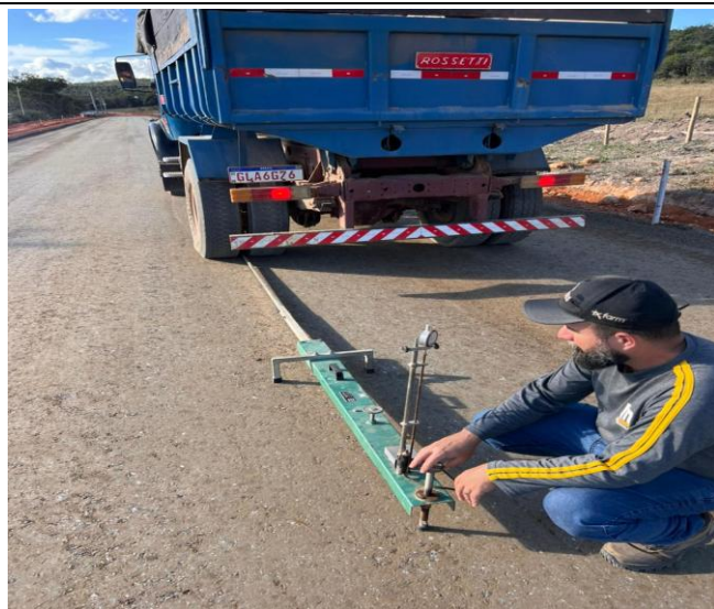
Foto 103 – Ensaio laboratorial de viga benkelman, liberação de base em BGS.
