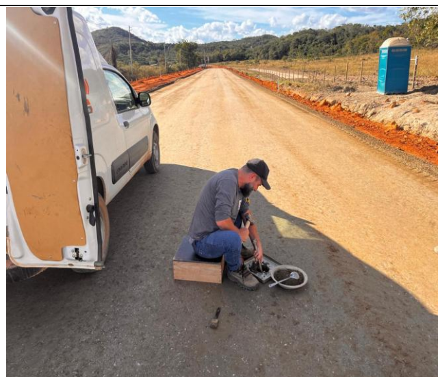
Foto 110 – Liberação camada de sub-base.
